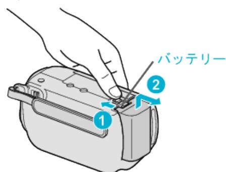
バッテリー取りはずしレバーをスライドさせて、バッテリーをはずしてください。
