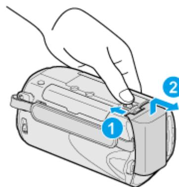
バッテリー取りはずしレバーをスライドさせて、バッテリーをはずしてください。
